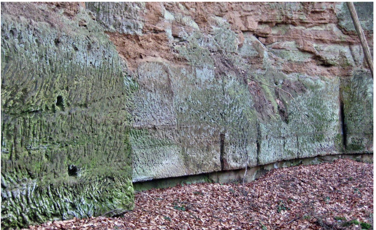
Abb. 3 Aufschluss L6, Laacher Tuff, Distrikt Am Verbrannten, Abbauwand mit Schrämpuren, 2009
